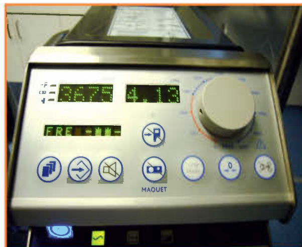
Fig. 4. Consola de bomba centrífuga.
