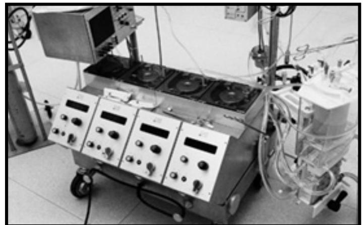
**Figura 1.** Bomba de rodillo pulsátil por Stockert (Munich, Germany).
